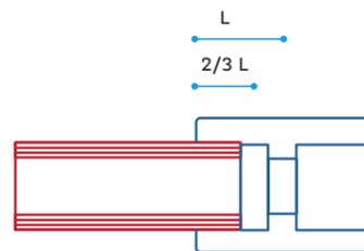
Figura 4. Termofusión a socket.
