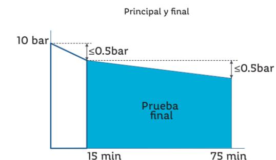
Para la prueba inicial se ha de conseguir una presión equivalente a 1.5 veces la presión de servicio máxima. Esta presión de prueba se debe mantener dos veces en el espacio de 30 minutos y con un intervalo de 10 minutos. Después de estos 30 minutos de prueba, la presión no debe descender en más de 0.6 bares y no deben aparecer fisuras.
