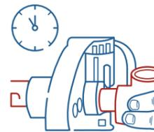
4. Mantén las piezas en los Dados del Termofusor el tiempo indicado para el diámetro de la Tubería (ver Tabla, 3 página 26).
